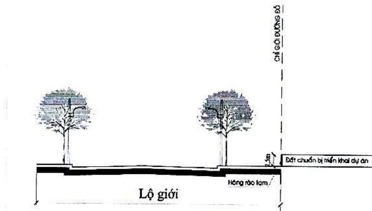
*Hình 2.9-Tường rào xây dựng tạm cho dự án chuẩn bị triển khai*
